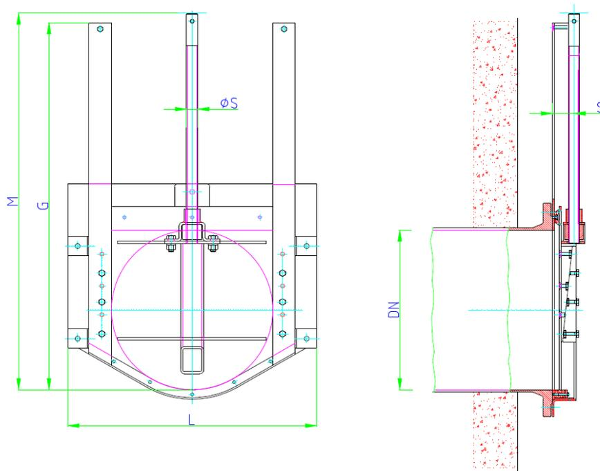
\* passend für bauseitigen Flansch DIN 2501 PN 10
