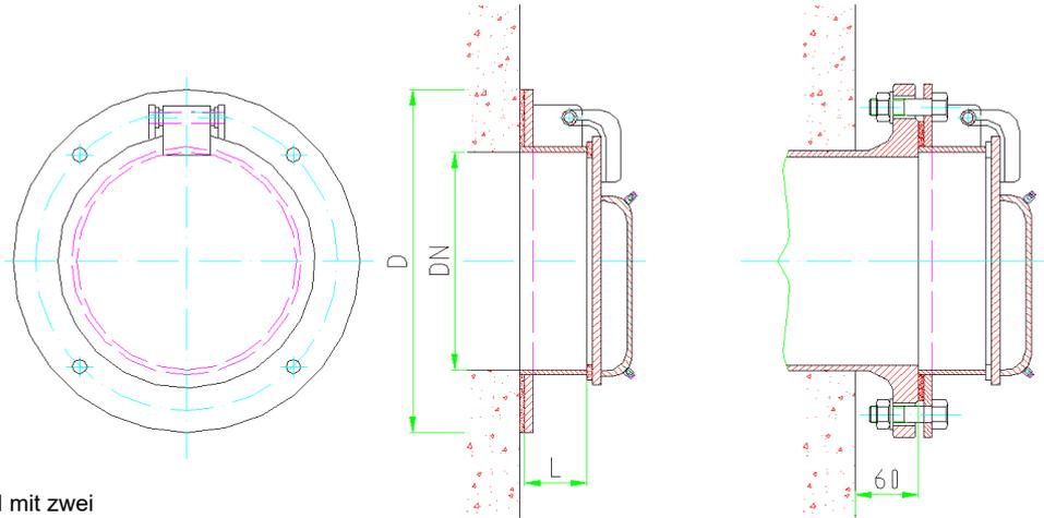
Schwimmerhohldeckel mit zwei Einfüllstutzen
