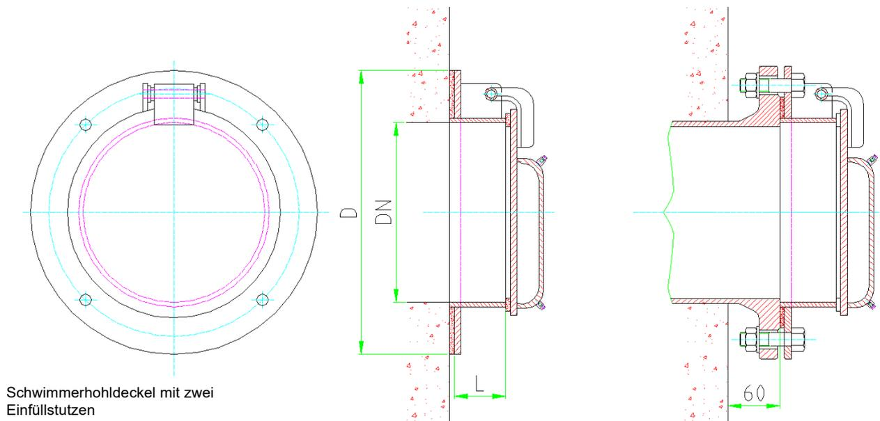
Schwimmerhohldeckel mit zwei Einfüllstutzen
