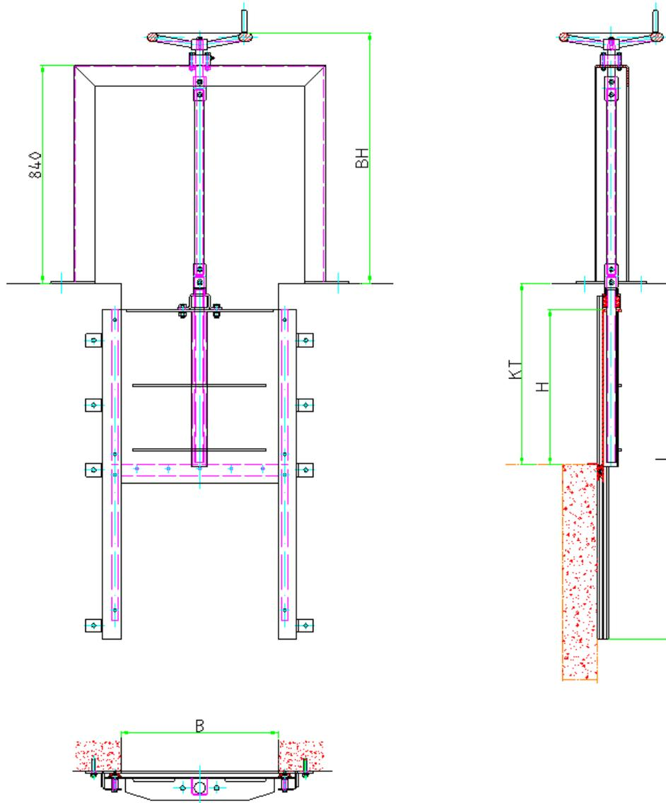
Konstruktion: Bauart TESACO, nach DIN 19569-4, 3-seitig dichtend
