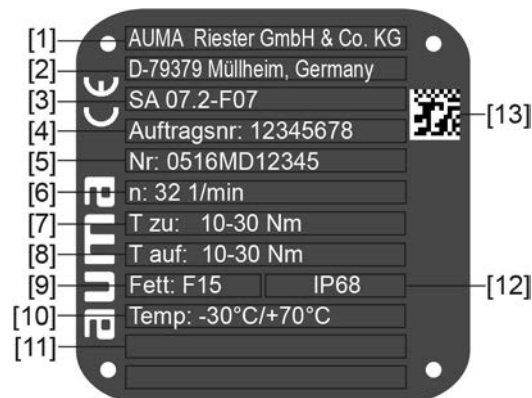
Bild 5: Typenschild Stellantrieb (Beispiel)
