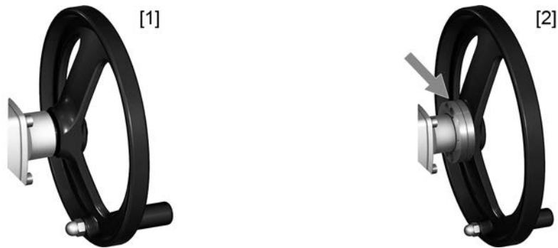
Bild 33: Handrad ohne/mit Überlastschutz
