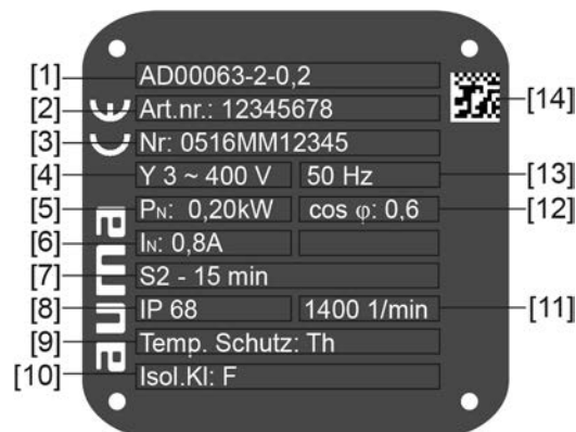
Bild 7: Typenschild Motor (Beispiel)
