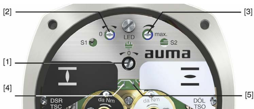
Bild 33: Blick auf Steuereinheit bei geöffnetem Schaltwerkraum
